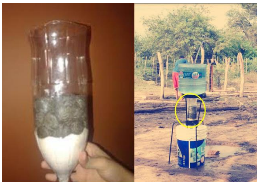
Figura 13: Filtro casero para agua
