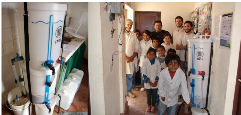
Figura 12: Dispositivo diseñado por personal del INTI para la remoción de As instalado en escuelas rurales de la provincia de Chaco.
